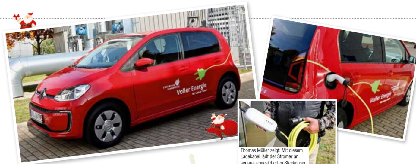
Thomas Müller zeigt: Mit diesem Ladekabel lädt der Stromer an separat abgesicherten Steckdosen.
